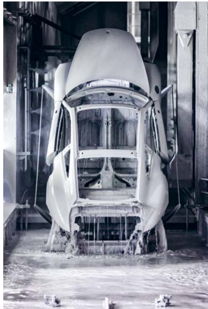
PRODUKTION ZUFFENHAUSEN: KATHODISCHE TAUCHLACKIERUNG
